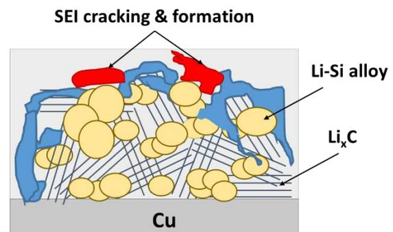
Spannungsfenster der Lithiierungsreaktionen der Si/C-Anode nicht stabil ist. Während der enormen Volumenveränderung der Si-Partikel kommt es zu Rissen und Ablösen von Teilen der SEI. Dieses führt dazu, dass neues Anodenmaterial freigelegt wird, an dem sich dann weiterer Elektrolyt zersetzt. Bei jeder Elektrolytzersetzung wird Lithium irreversibel gebunden, was bei wiederholtem Laden und Entladen der LIB zu einem Kapazitätsverlust führt.
