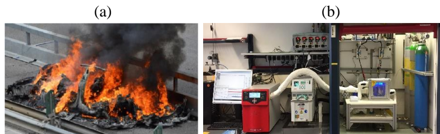
Abb. 1: (a) Brennendes Elektroauto infolge eines Sicherheitsversagen der Lithium-Ionen Batterie, ( https://www.golem.de/news/elektroautos-in-tiefgaragen-was-tun-wenn-s-brennt-2001-146056.html , abgerufen am 04.01.2021). (b) Messaufbau des DEMS: Gasanalysesystem (links) mit Messzelle (rechts), IAM-ET.
