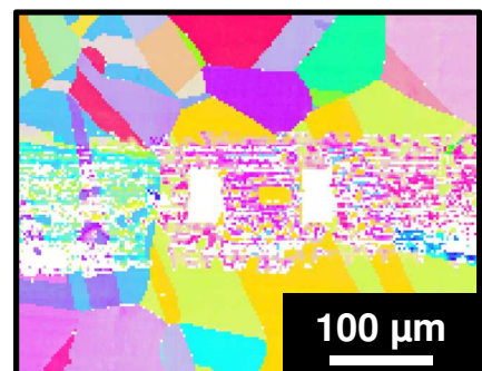
EBSD-Messung nach Tribo-Experiment
