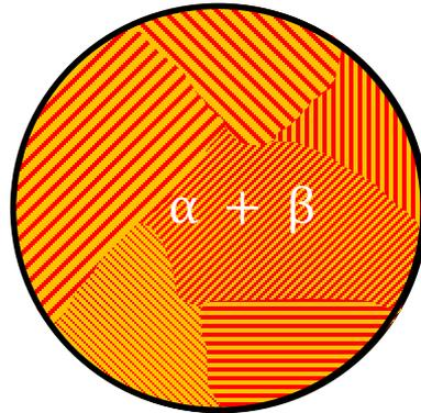
Lamellare, faserförmige oder würcchenförmige Anordnung der beiden festen Phasen in unterschiedlich orientierten Kolonien.
