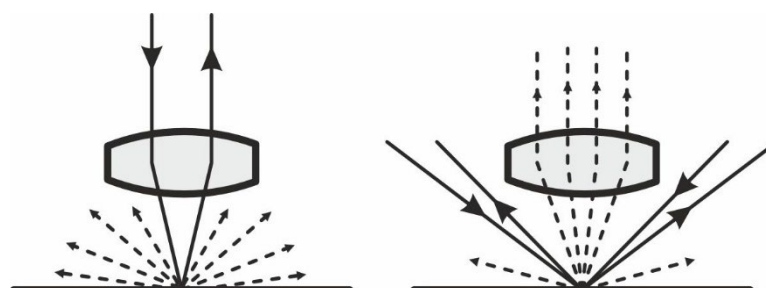
Abbildung 9: Schematische Darstellung der Strahlenverläufe bei LOM-BF (links) und LOM-DF (rechts) nach [1]. Durchgezogene Linien stellen die reguläre Reflexion dar, gestrichelte Linien diffus gestreute Strahlung.
