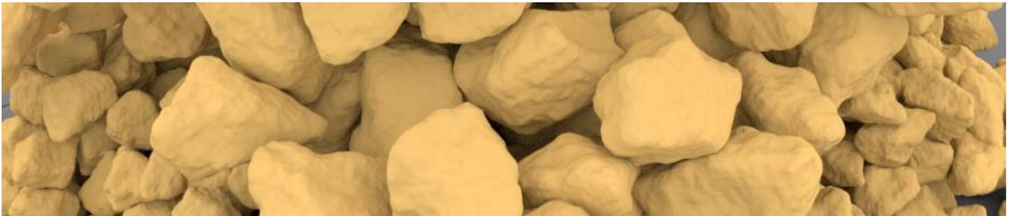
Für den Bau spezieller Brunnenysteme muss der Fluss von Grundwasser durch das Erdreich abgeschätzt werden. Der Einfluss der Mikrostruktur von Sand auf diese Durchströmungen ist dabei ein wichtiger Einflussfaktor, der mit Simulationen bestimmt werden kann. Die Grundlage dieser Simulationen sind auf realen Proben basierende Rekonstruktionen der Mikrostrukturen.
